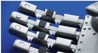
ロボットハンド用超薄型フレキシブル触覚センサー
