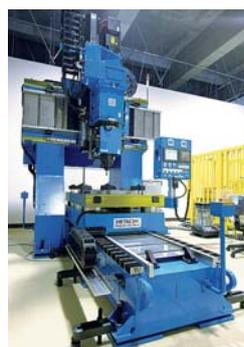
2次元摩擦攪拌接合装置
