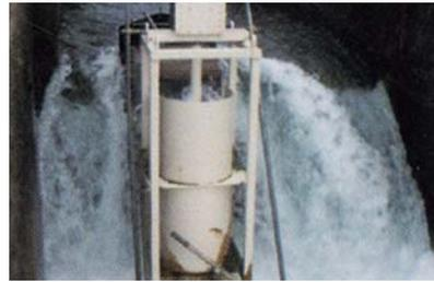
低落差(1m)でも効率的な発電が可能なマイクロ水力発電機
