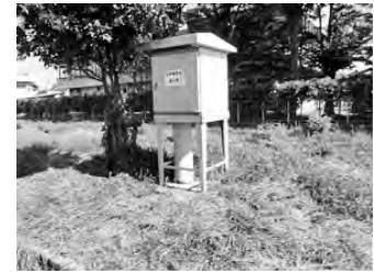
地下水位観測井
