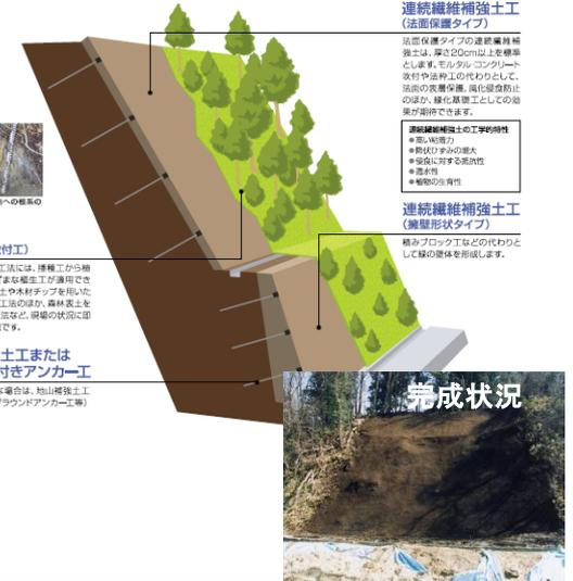
補強材としてロックボルトを地山に削孔挿入し、セメントミルクで固定します。その後、頭部に支圧板を取り付けます。
