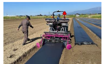
トラクタの直進アシスト 機能によるうね立て
