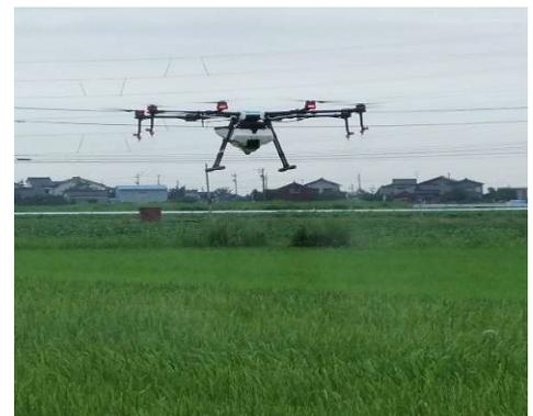
写真 ドローンによる適期防除
