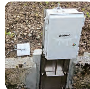
▲自動給水栓(開水路型)
