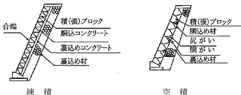
図3-5-3 コンクリートブロック工
