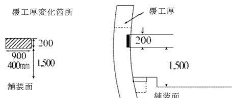
図7-5-1 覆工厚変化箇所の刻示標準図
