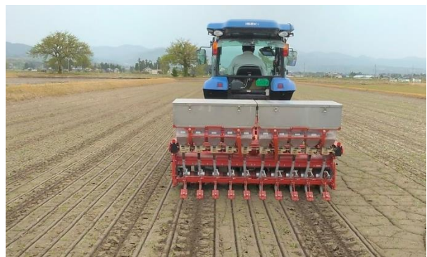
水稲乾田V溝直播栽培の播種作業
