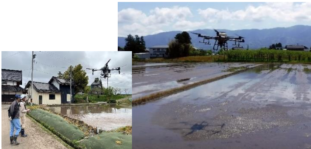
農業用ドローンを用いた水稲直播栽培（播種作業）
