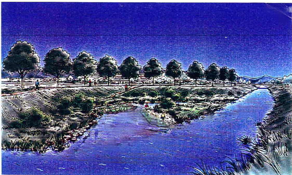
図 4 スポット整備の例（自然環境に配慮したワンド）
