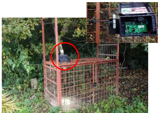
獣サイズ判別センサー式自動捕獲システム
