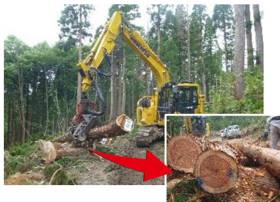
マーキングや通信機能を備えた高性能林業機械（ハーベスタ）
