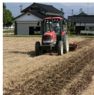
写真 ロータリによる耕起
