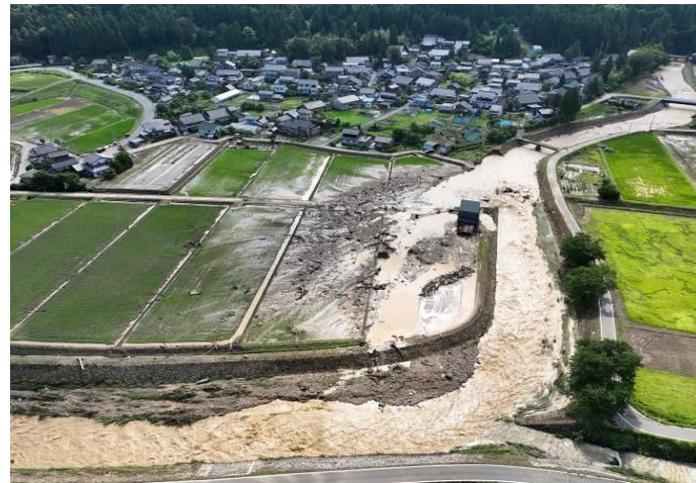
白岩川の護岸欠損による被災状況
