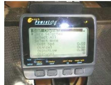
艇にかかる力の強さと長さ、オール振り角度、チームボートでの漕動作のズレのチェックなど、肉眼では捉えにくい詳細なデータを取得し、漕力やスキルの可視化を図っている。導入によって、効率良く艇を走らせる技術が向上し、競技結果に結びついている。
