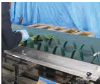
▲障害のある人が作業しやすいように、治具の開発を行うこともある。写真の治具は、収穫物のサイズを揃えて袋詰めしやすいように作ってある。
