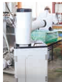
▲夏は屋内外を問わず注意が必要。熱がこもりやすい屋内作業場には冷風機などを設置し、環境を整える。
