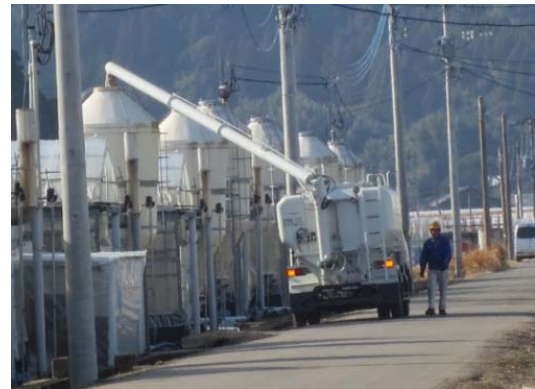
貯蔵タンクへの燃料の投入
