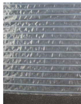
中空構造資材の構造（例）
