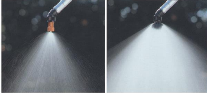
図2 散布粒径が粗いノズル(左)の使用による農薬の散布状況 (右は一般扇形ノズル) 出典: 農薬散布時のドリフト防止対策ガイダンス
