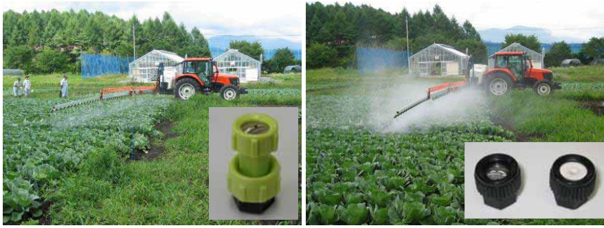
図1 使用ノズルの違いによる農薬の飛散の状況 (左: 飛散低減ノズル、右: 通常ノズル) 出典: ドリフト低減型ノズルパンフレット
