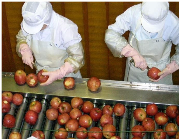
図2 ジュース工場での果実の不良箇所の除去作業 (試験的に、加害の多いりんごを用意して行ったもの) (協力:長野興農(株)須坂工場)
