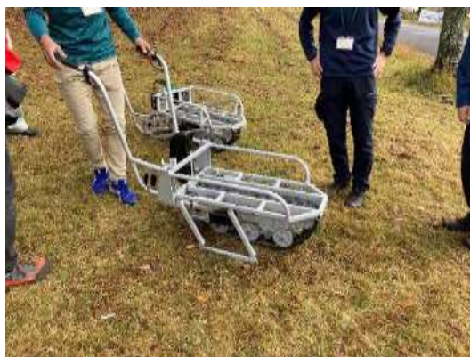
写真7-1 アウトリガー付き苗木運搬機
