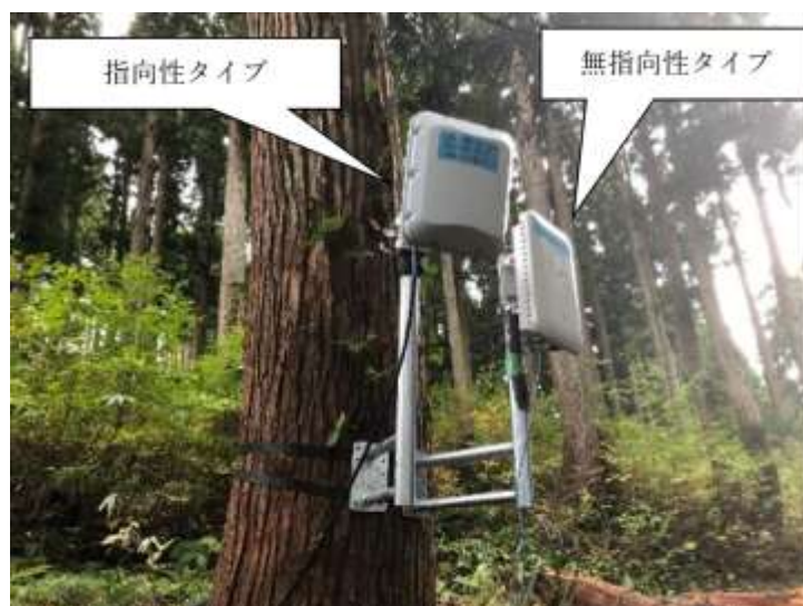
図-17 無指向性タイプの設置（写真左の機器：比較用指向性タイプを併設）
