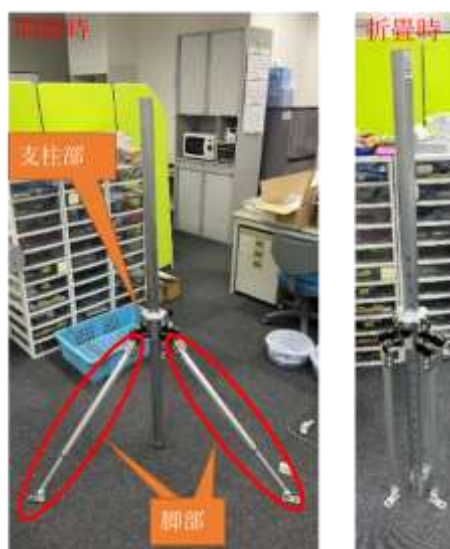
図-16 三脚型仮設架台
