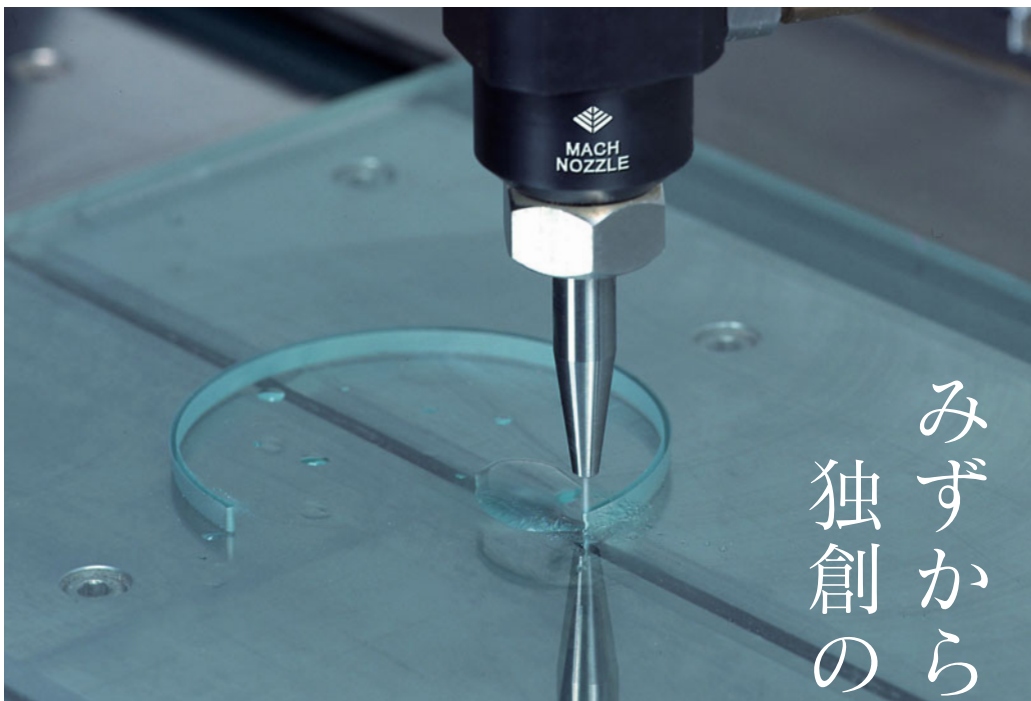
制御のしやすさも、ウォータージェットの大きな特長。複雑な形状も自由自在に加工する
