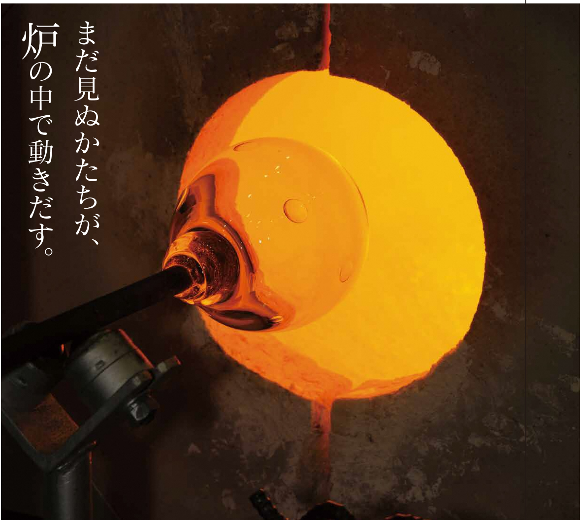
熔解炉で1200℃に熱せられたガラスが目映い光を放つ。
