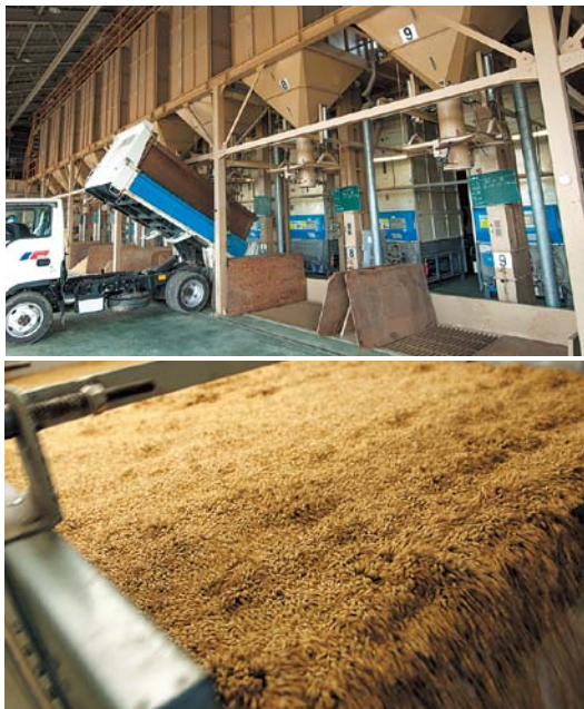
上/専用乾燥機も一品種の乾燥が終わるたびに清掃される。 下/調製プラントでは未熟粒などを選び分け、優良種もみだけを選別する
