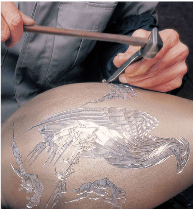
銅器の表面に細密な図柄を浮かびあがらせる彫金の技法
