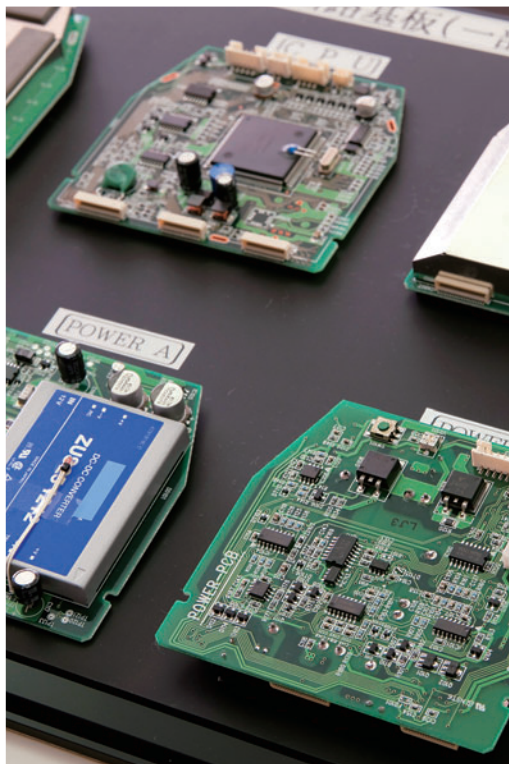
パソコン2台分に相当する情報処理能力を持つPARO専用回路基板
