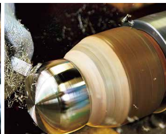
形を整え音程を調整する切削
