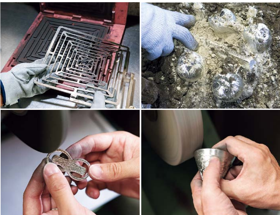
右上：砂型を割ると温かみのある鑄肌が姿を見せる 右下：手の感覚を頼りに口縁を磨いて仕上げる 左上：「KAGOシリーズ」は細かな造形に適したシリコン型で鑄造する 左下：細かな部分の仕上げにこそ職人はこだわりを込める
