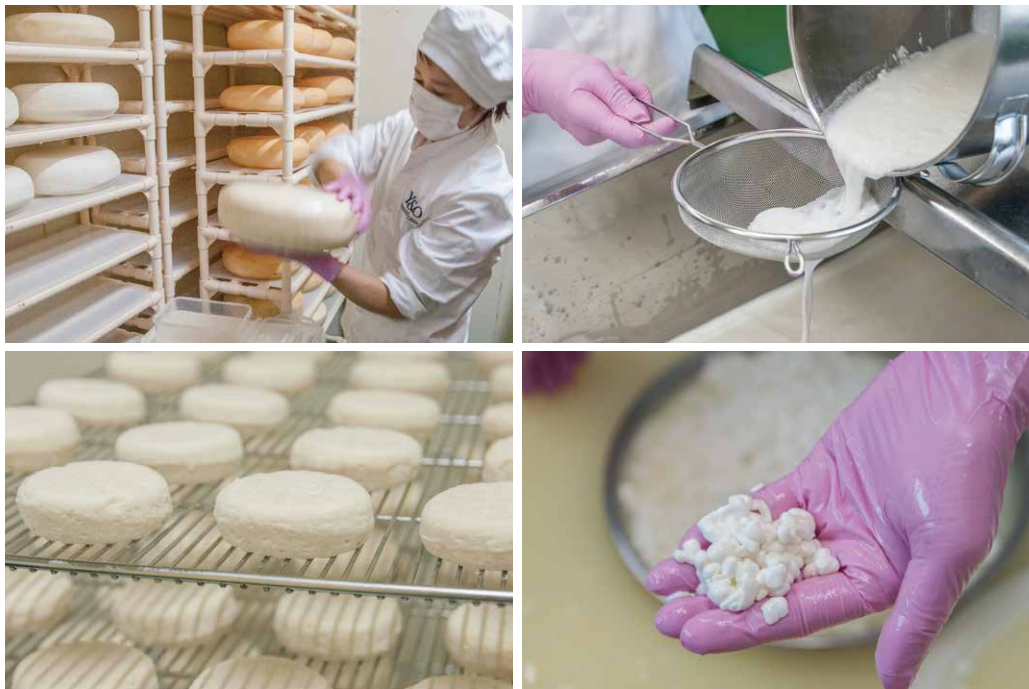
低温殺菌した生乳に乳酸菌や凝乳酵素を加え、凝固させてチーズの元となるカードを作る。 カードから乳清などの水分を抜いた固形物をチーズの形に整え、海洋深層水に浸して熟成させる。
