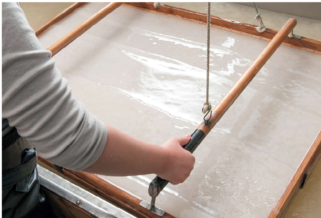
流し漉き＝溶けた繊維が絡み合って紙となるまで作業を何度も繰り返す
