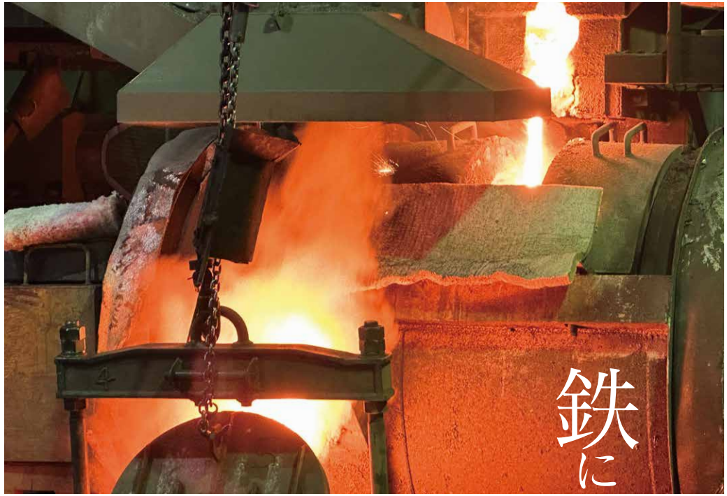
コークスが燃えるキュポラの中で、原料の鉄は1,550℃に熱せられ、オレンジ色のまばゆい光を放つ。
