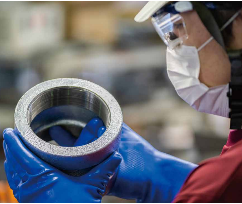
鋳造した継手に焼きなましや切削加工を施し、強靱で精度の高い製品に仕上げていく。
