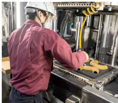
鑄砂を固めて内子と外子からなる鑄型をつくる。
