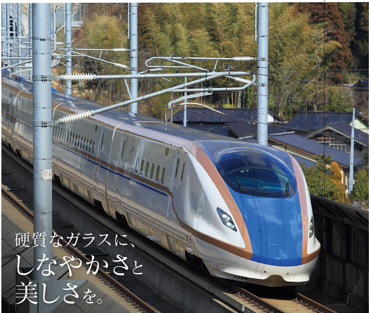
車体と連続した寸分たがわぬ成型と強度が求められる新幹線のフロントガラス。 北陸新幹線「かがやき」には、鉄道分野で国内トップシェアを誇る新光硝子工業の3次元曲面成型ガラスが使用されている。
