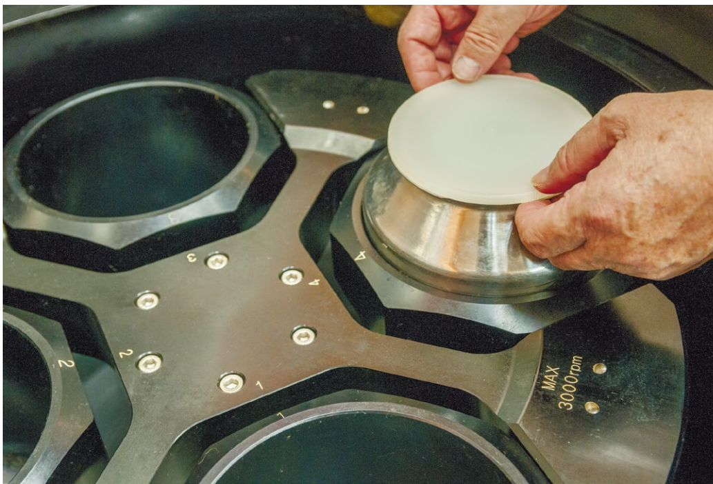
遠心分離機は1分間に3,000回転し、油分、魚醤の元、固形物の3層に分離することができる
