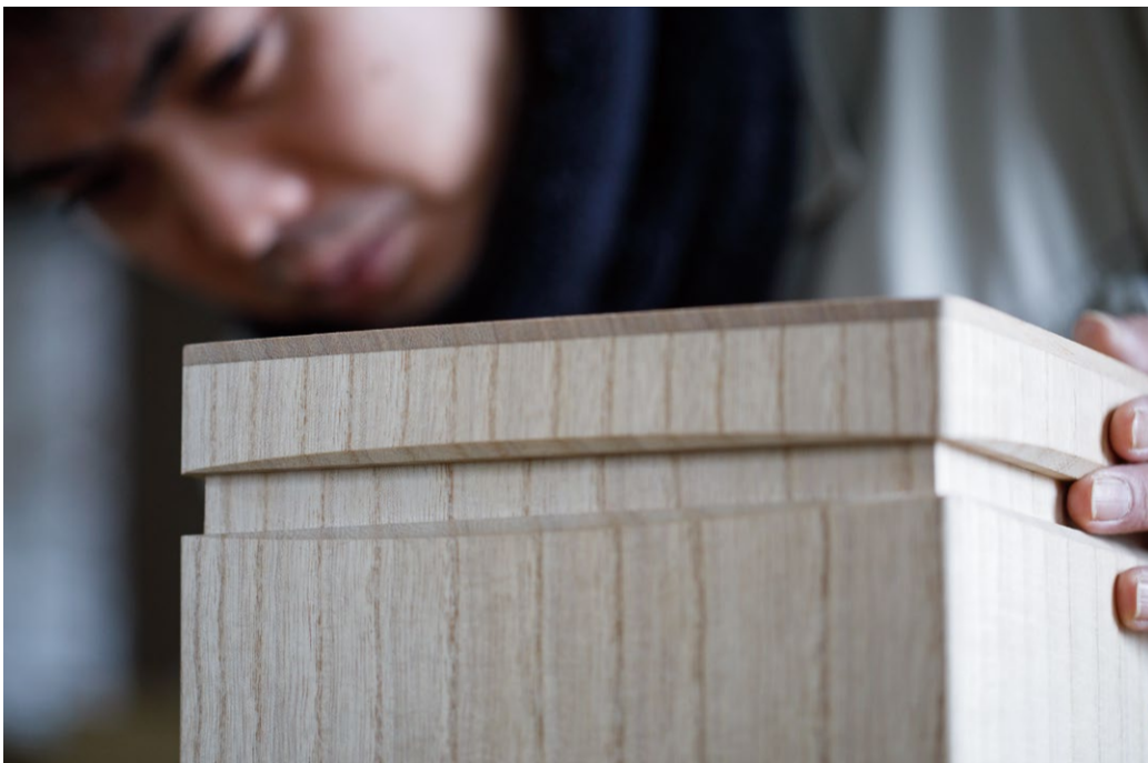
どの向きでもびったり蓋が閉まるよう緻密な調整を繰り返していく。高い密閉性は美術木箱うらたの技術力の高さを証明する。
