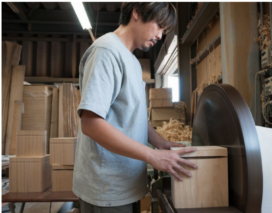
大きな歯がついた「円盤」にかけて、手なりの良い緩やかな曲面を削り出す。洗練された高い加工技術が求められる工程。
