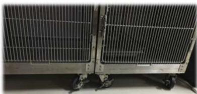
キャスターをロックしていても大きな揺れで 移動してしまった
