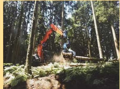
高性能林業機械による造材 (魚津市長引野)
