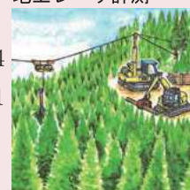
タワーヤーダ (架線集材)
