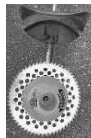
図1 刈払機用安定板 （高刈り時に装着）
