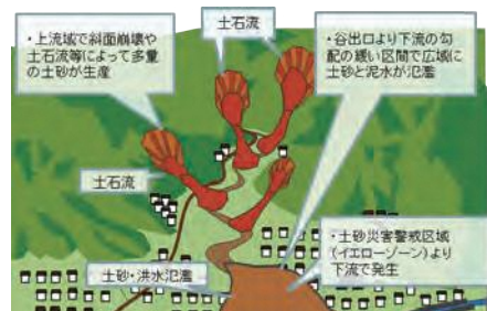
土砂・洪水氾濫イメージ図（国土交通省HPより）
