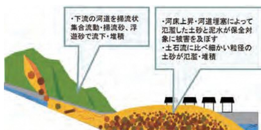
土砂・洪水氾濫イメージ図（国土交通省HPより）
