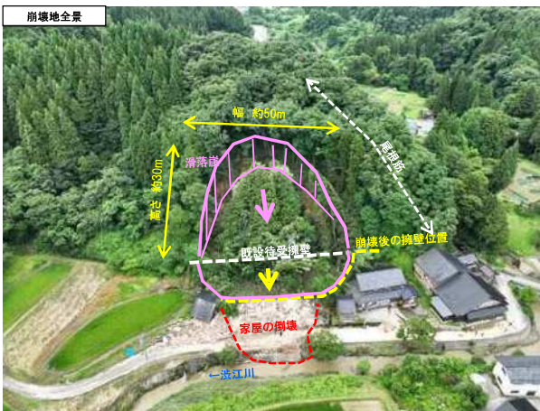
崩壊地の頭部～側部にかけて明瞭な滑落崖を形成している 斜面の地質は強く風化した泥岩 崩壊土砂は層状に移動した
