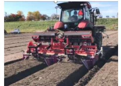
スマート農機を活用した大区画ほ場でのたまねぎの畝立て作業
