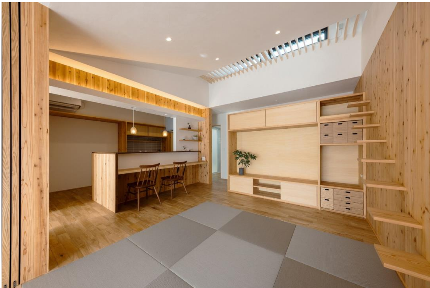
県産スギ板で囲まれ、高窓から光が差し込むリビング。造り付けの造作家具も30mm厚の県産スギを使って造られている。
