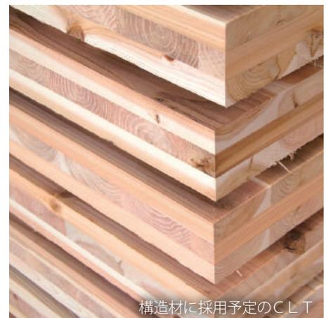
構造材に採用予定のCLT
