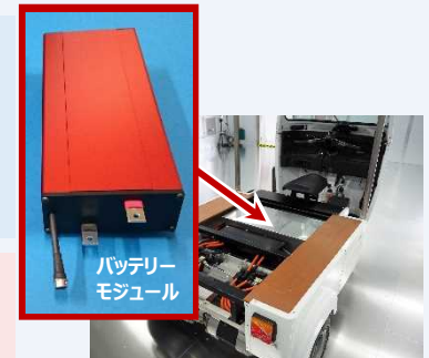
試作した小型EV用バッテリー
