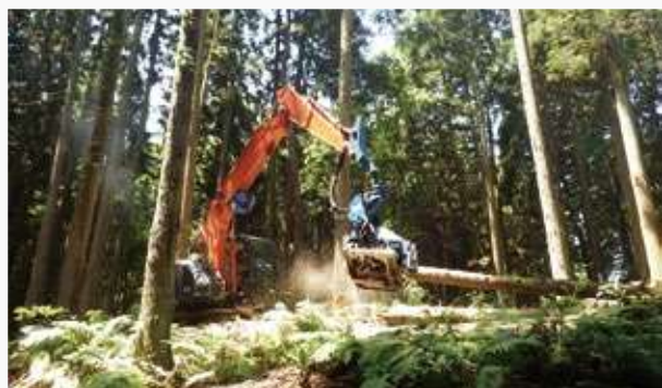
▲高性能林業機械（ハーベスタ）による間伐作業状況
