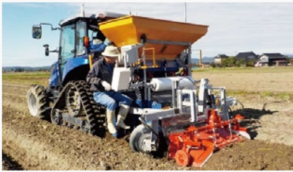
▲実証・普及が進められているチューリップ球根のネット栽培 (専用小型機械による球根の植込作業)
