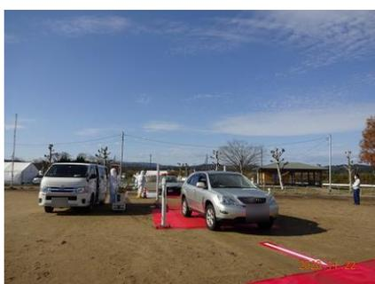
ゲートモニタによる汚染検査
