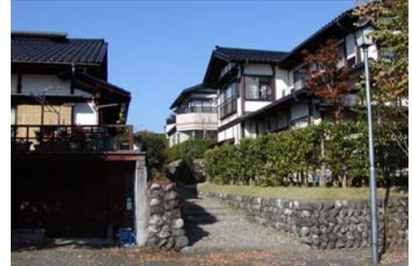
擁壁に地場の自然石を使用して造成している。(富山市)
