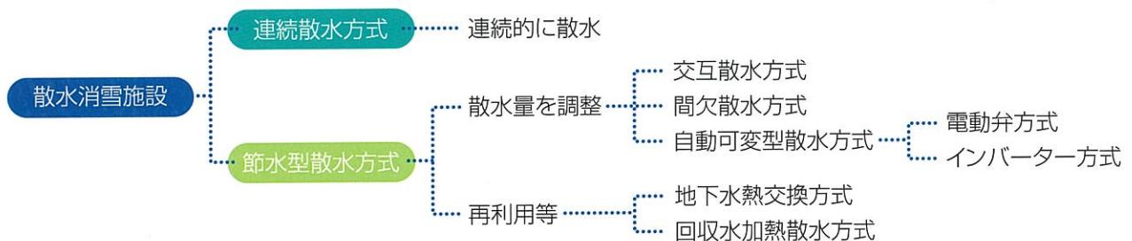
節水型散水消雪方式は、連続散水方式と比べると、節水運転制御のための設備を付加するために建設費が10~15%程度高くなりますが、30~60%程度の節水、
