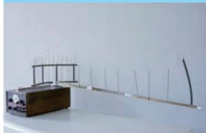
八木・宇田アンテナ。1930 (昭和5) 年のベルギー博覧会に出品されました。(東北大学電気通信研究所提供)
