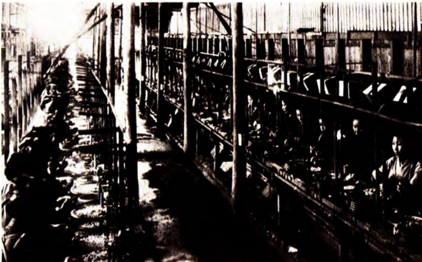
明治後期の製糸工場 繭から糸口をみつけて、糸巻に生糸を巻きとる。枠は、水車か蒸気の動力によって回転。八尾町
