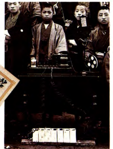
電信機 当初のころのモールス式印字機
