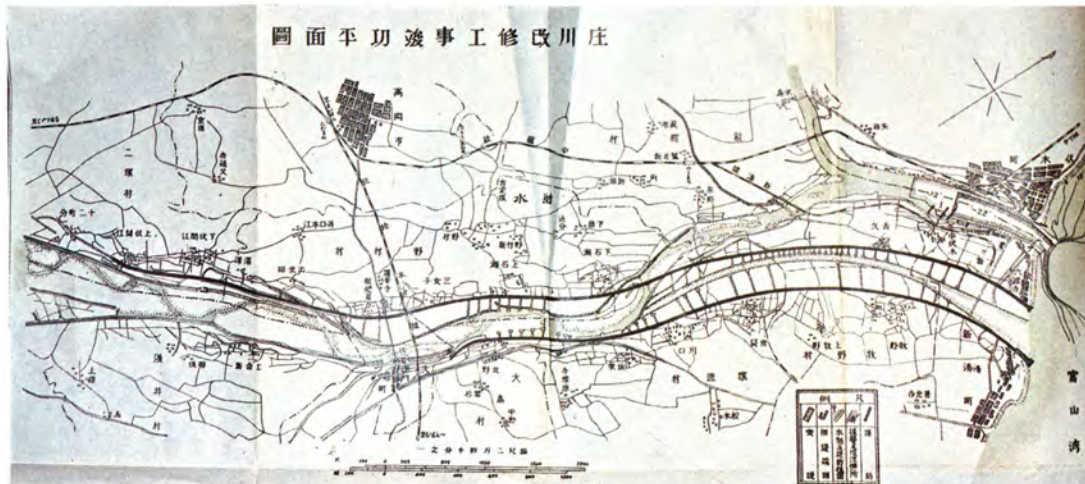
庄川改修工事竣工平面図 小矢部川と合流していた庄川は 洪水の災害を少なくするため 別に海に注ぐようにつけかえられた
