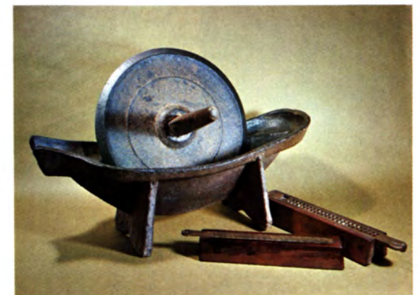
薬研と下榼 粉薬をつくる薬研と丸薬をつくる下榼は 製薬の重要な道具であった
