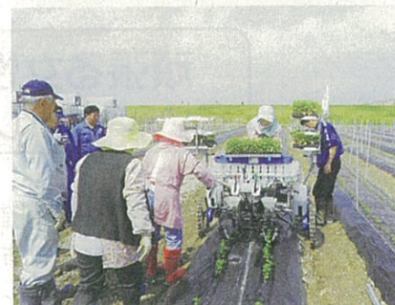
写真2 キク専用半自動乗用移植機の現地実証
