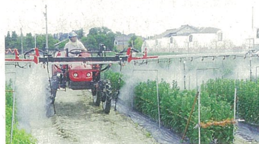
写真3 ブームスプレーヤーを利用した病虫害防除の省力化
